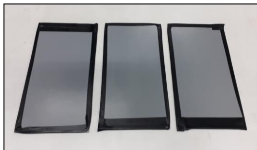
Foto 3 – Amostra sem regiões de solda após 20 ciclos em exposição
