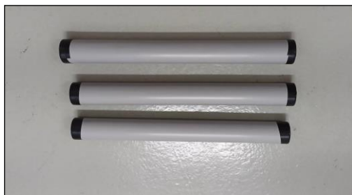
Foto 2 – Amostra sem regiões de solda antes do ensaio
