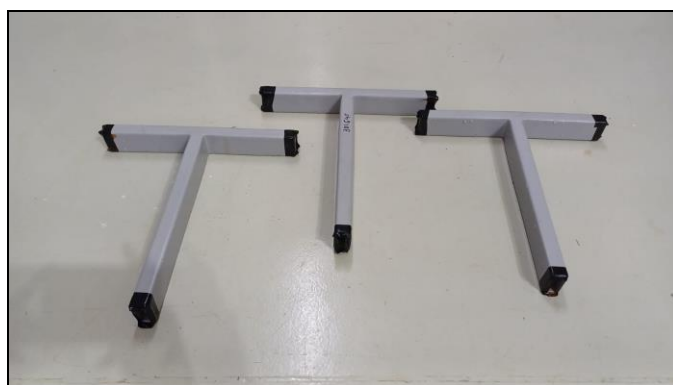
Foto 3 – Amostras com regiões de solda após 2040 horas em exposição
