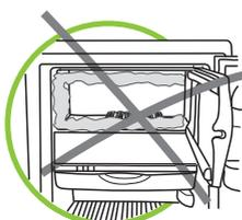
Faça o degelo periódico antes que a espessura de gelo ultrapasse a altura do perfil indicador de degelo, localizado no topo do congelador, conforme ilustração. Se a espessura do gelo for maior que a altura do perfil, o tempo de degelo aumenta, podendo não descongelar completamente e ainda transbordar água na bandeja de degelo. Neste caso recomenda-se realizar o "Degelo Manual".
